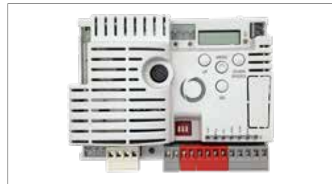
Centrale de commande CT10224 avec récepteur intégré
