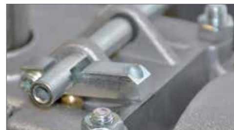
Déblocage extérieur possible avec câble en acier
